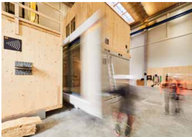
ABB. 2. Einbringen eines Prüfkörpers mit Hilfe des Hallenkrans zwischen dem Sende- und Empfangsraum zur Luftschallmessung.
