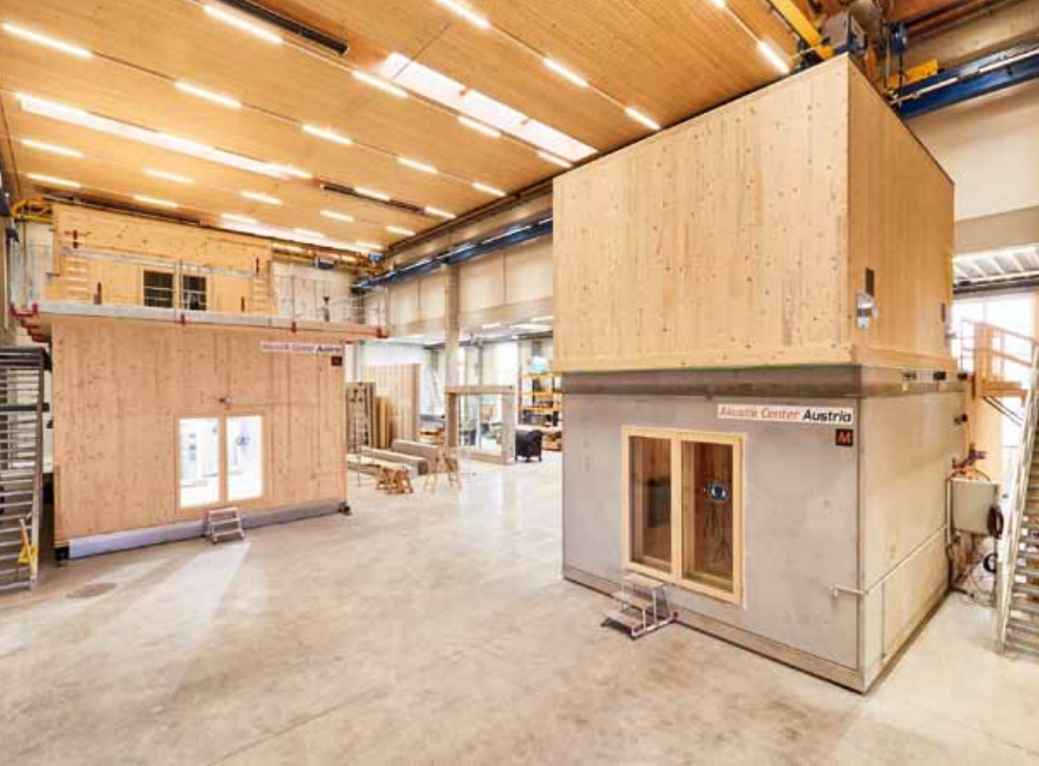
ABB. 1. Hier wird die Innenansicht des Akustik Centers Austria mit den beiden errichteten Prüfständen gezeigt. Rechts im Vordergrund ist der normative M-Prüfstand, u. a. um akkreditierte Schallmessungen zu erkennen. Links im Hintergrund der Forschungsprüfstand (XL-Größe) zur exakteren Betrachtung des tief-frequenten Bauteilverhaltens. Bei beiden Prüfständen sind die Empfangsräume in Stahlbetonbauweise und die Senderäume in Brettsperrholzbauweise ausgeführt. Die leichteren Senderäume sind auf Schienen gelagert oder lassen sich mit den vorhandenen Schwerlastkränen bewegen. Hierdurch können vorgefertigte Prüfkörper schnell zwischen dem Sende- und Empfangsraum platziert werden, was einen raschen Versuchsablauf ermöglicht.
