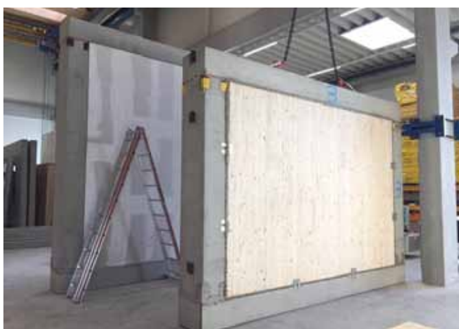
ABB. 4. Hier werden die Prüfraumen des M- und XL-Prüfstandes zur Luftschalluntersuchung von vertikalen Bauteilen gezeigt. Für Deckenprüfungen wird ein dementsprechender horizontaler Prüfraumen verwendet. Damit die Prüfstände bei Umbau- oder Trockenzeiten von Prüfkörpern nicht unnötig blockieren werden, sind mehrere Prüfraumen zur abwechselnden Bestückung der Prüfstände vorhanden.
